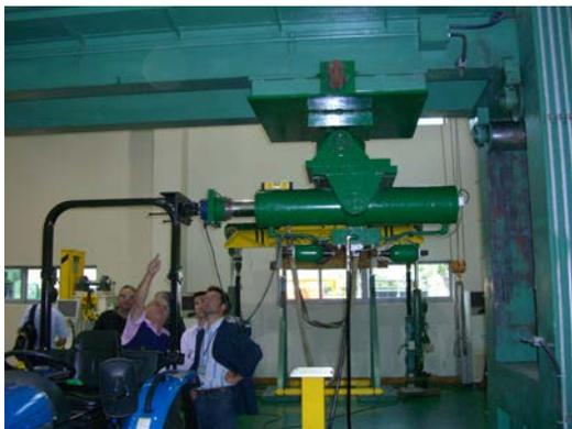
図 17 ROPS 試験装置
