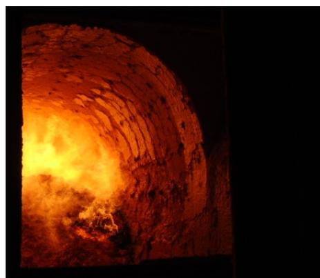
図 5 籾殻燃焼炉内の様子
