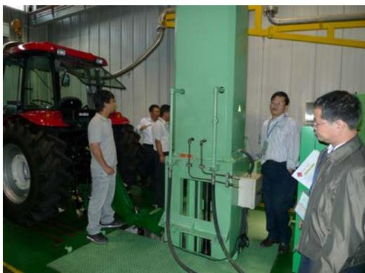
図 19 作業機昇降装置性能試験装置
