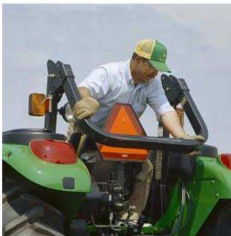
図 9 フレームの引き起こし作業
