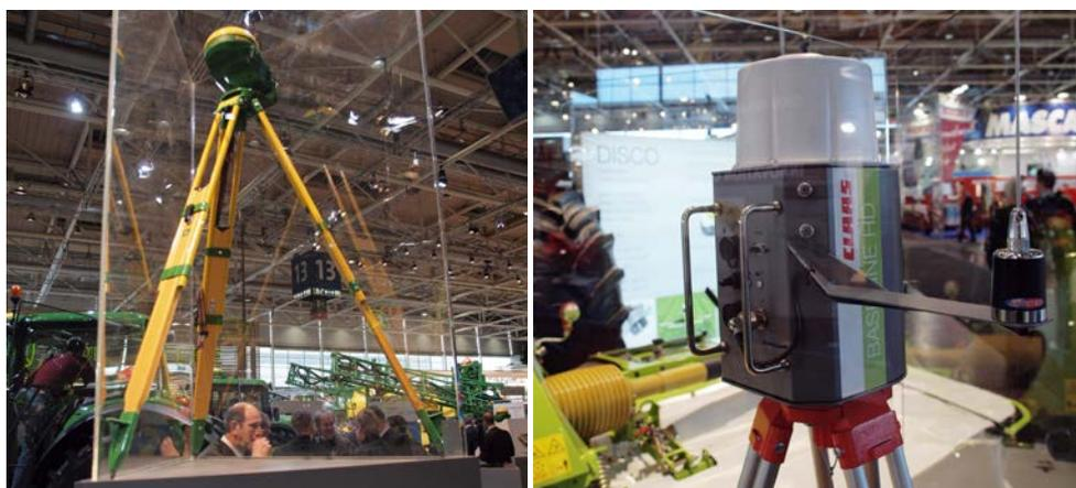
図 6 基地局設置型 DGPS（基地局）
