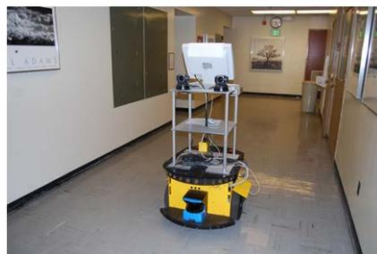
図3 建築物を自律走行してデジタルモデルを構築するロボット (Khalil 氏)
