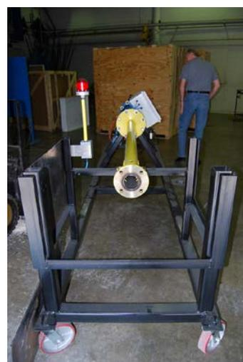
図 1 高速射出装置 (Grift 先生)
