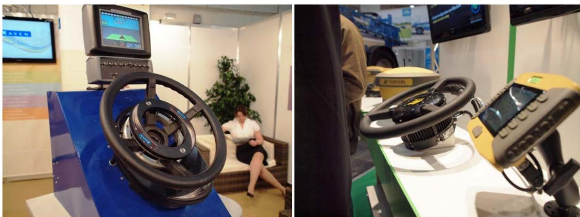
図 5 後付型ステアリングコントローラ
