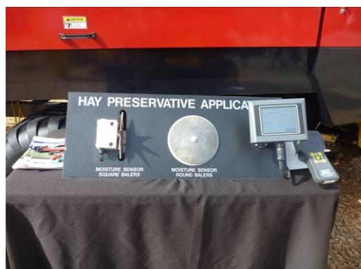
図 19 水分計測システム
