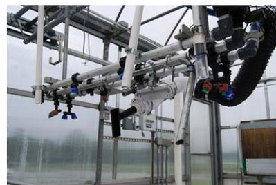
図4 圧縮空気をを用いた防除装置
