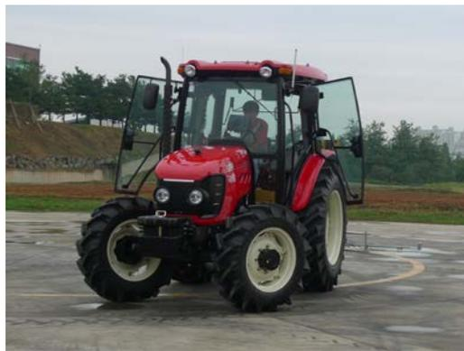
図 8 旋回半径測定
