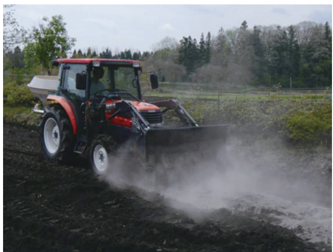
図7 フロントローダによる転炉スラグ処理
