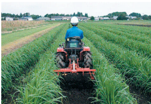
写真1 条間120cm 広条播種区における13PS 小型トラクタを用いた中耕作業
