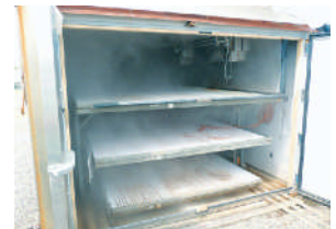
(上写真) イチゴ苗の病害虫を防除する蒸熱処理装置
