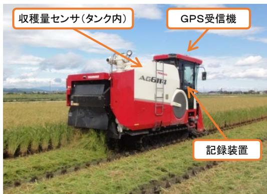
図4 記録装置を搭載した収量コンバイン
