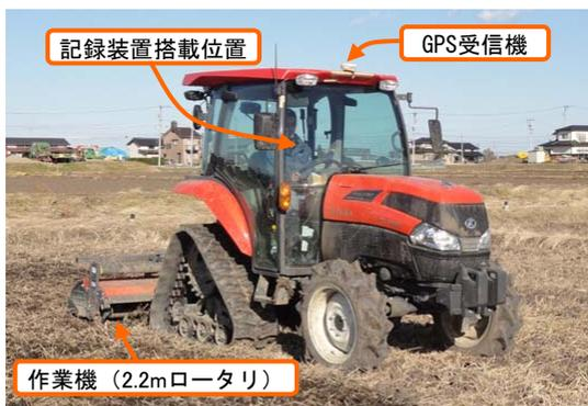
図2 記録装置を搭載したトラクタ
