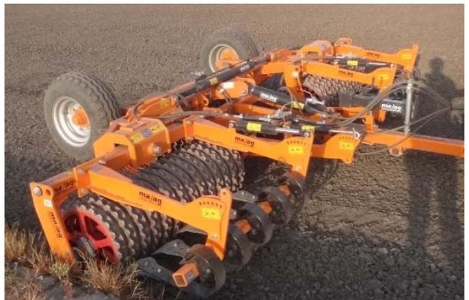
図1 ケンブリッジローラによる鎮圧作業
