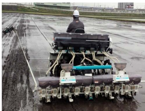
図1 開発中の10条鉄コーティング用点播機
