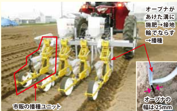
労働時間の短縮をめざした業務用タマネギの直播栽培（写真は、播種位置のすぐ下へあらかじめリン酸肥料を施用できる播種同時施肥装置）
