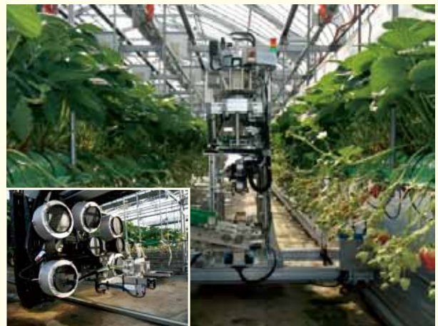
LED照明とCCDカメラによる画像処理ののち、熟したイチゴのみを収穫するイチゴ収穫ロボット
