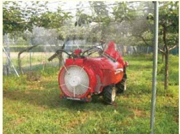
ドリフト（農薬の飛散）や騒音の低減効果が高いスピードスプレーヤー
