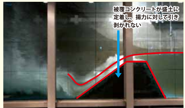
津波に対して粘り強い堤防開発のための模型による水理実験（右側から人工的な津波を作用させた堤防模型の挙動を観察）
