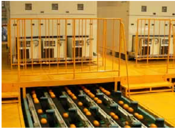
図1 温州ミカンの糖度選別装置。各選果ラインのセンサーが分光装置の子機に相当する。
