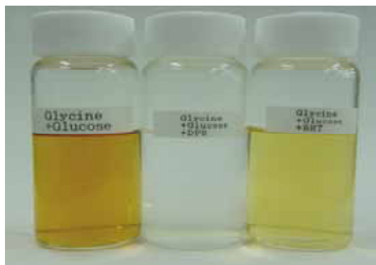
図3. 非酵素的褐変に及ぼすジイソプロピル硫黄化合物の阻害効果
