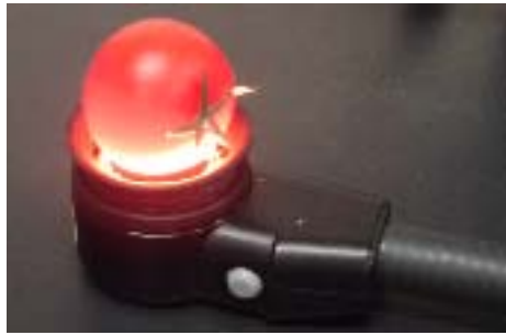
図1 トマト品質の非破壊計測 (インタラクタンス方式) 光ファイバー末端の試料台の外側から可視・近赤外光がリング状にトマトに照射され、吸収された光が試料台の中央部にある受光部で検出される様子を示す。
