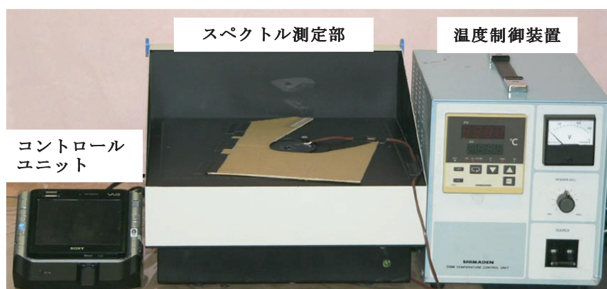
図 1 試作した血糖値測定用分光装置（1号機）
