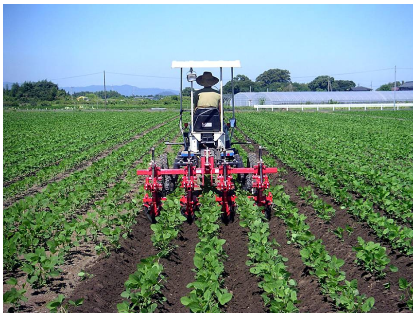
(図 2 - 3 2) ディスク式中耕除草機による培土作業
