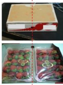
図1 実測とシミュレーションとの整合性確認の対象とした包装容器（縦 210×横 290 × 高さ 45.3 (mm)）
