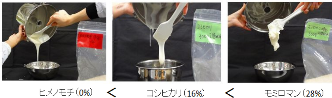
図2 品種(アミロース含量)の違いによる米ゲルの物性
