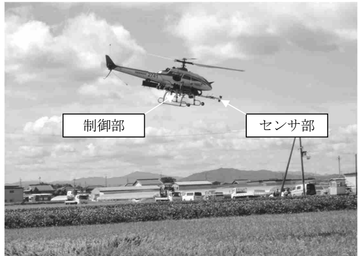
図2 空中測定の様子（速度5m/s、高度3m）
