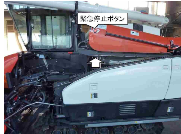
図2 通常作業型(挟やく桿開放式) (挟やく桿が開放した状態)
