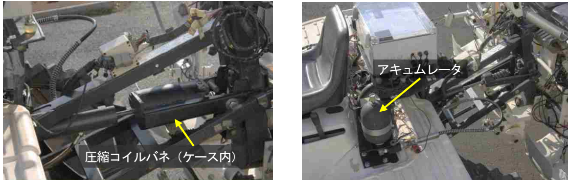
図2 作業機昇降制御機構（左：圧縮コイルバネ、右：アキュムレータ）
