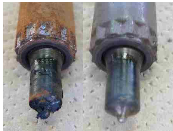
図4 噴射ノズルの様子 (左: カーボンの付着あり、右: カーボンの付着なし)
