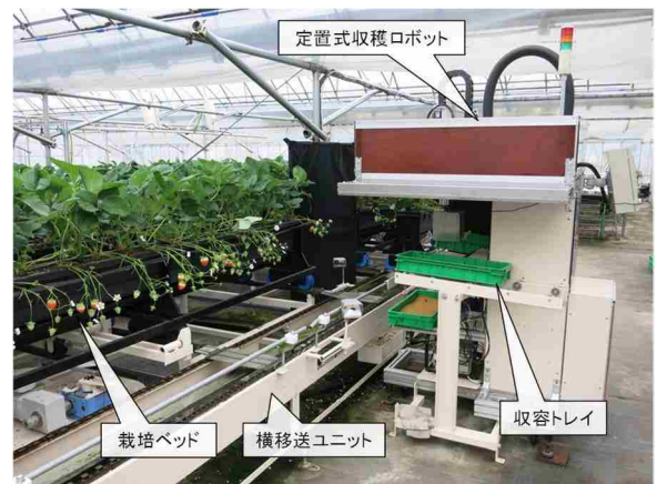
図4 定置型収穫ロボットと循環式移動栽培装置の連動
