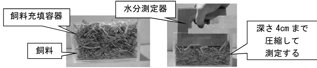
図1 サンプル法による測定方法（左：圧縮前、右：圧縮時）（2011）
