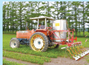
飛散防止アタッチメントを 装着した直装式スプレーヤ
