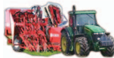
3畦引き抜き式収穫機（テンサイとニンジンで汎用利用）
