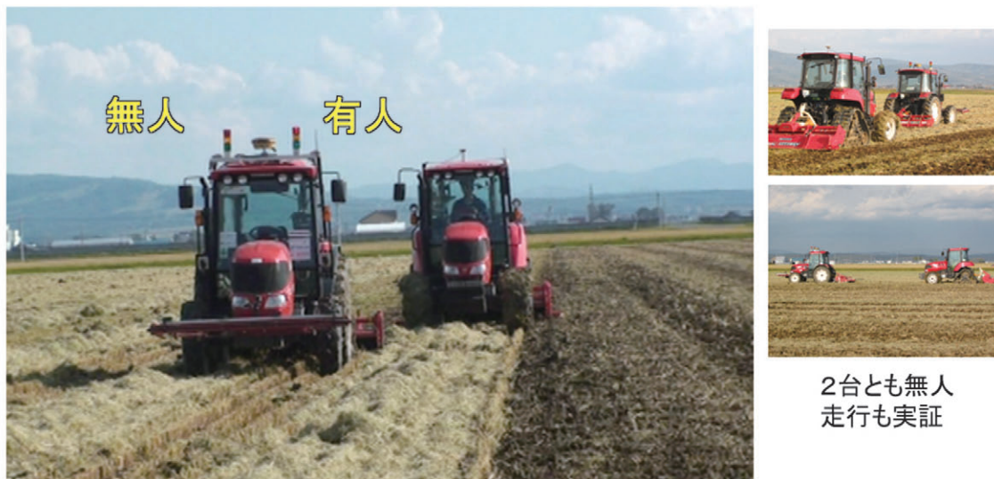
写真 現地での2台協調耕耘作業実証（北大） （平成26年9月22～23日）
