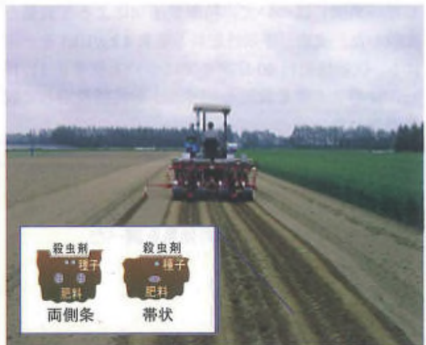
図3-4 施肥播種機による直播の様子と畦断面の模式図
