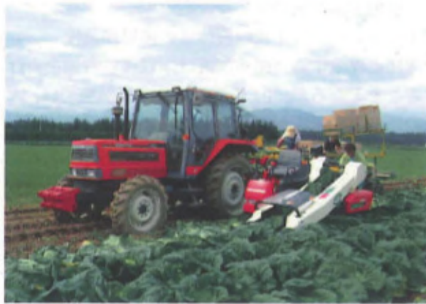
図 2-25 トレーラ伴走式収穫体系
