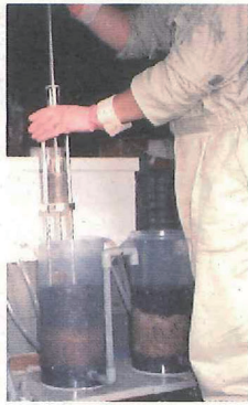
写真 2-1 暗渠疎水材の透水性変化を測定するための塩ビ製円筒
