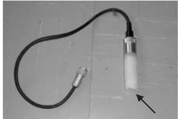
図2 観測に使用したガラス電極式CO 2 センサー プローブの直径は3cm、長さは約17cm。矢印の部分に隔膜がある。
