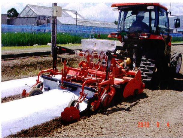
図2. 耕うん同時畝立て局所施肥マルチ作業機
