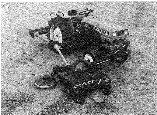
図1 果樹園用中耕装置OC-71型
