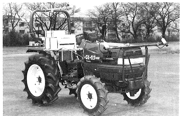
図4 トラクターをベースにした試験用車両
