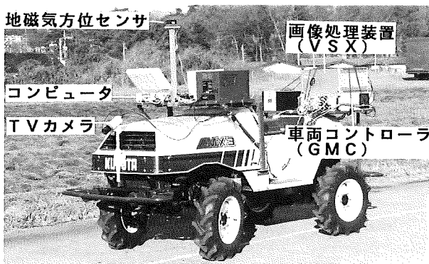
図1 芝刈機をベースにした試験用車両
