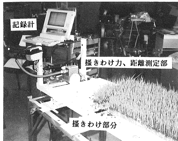
図1 マット苗の掻きわけ試験器
