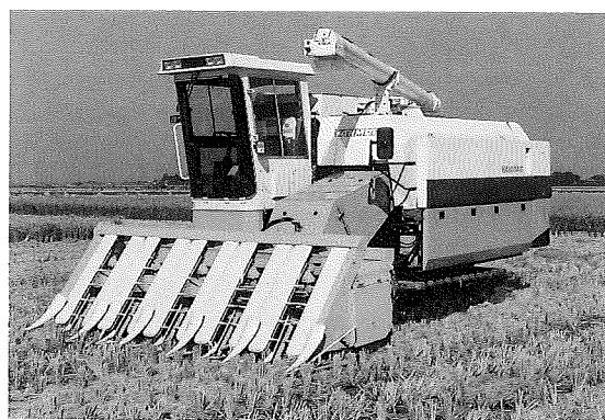
図2 Rヘッダを装着した大型汎用コンバイン
