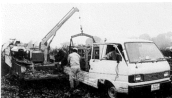
写真2 クレーンによるコンテナの荷下し
