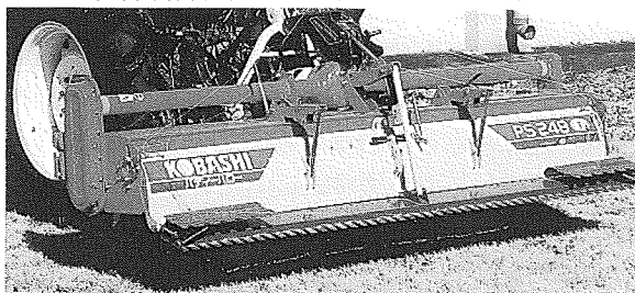
写真1 開発機（一体式、作業幅2.4m）
