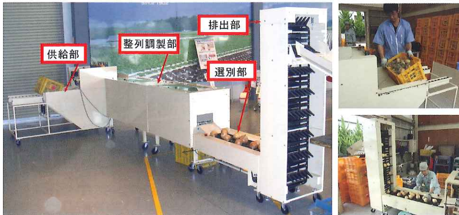
図1 たまねぎ調製装置(左:全体外観、右上:供給部での作業、右下:選別部での作業)
