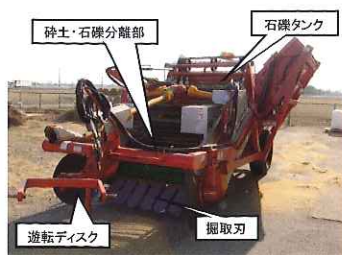
図1 石礫除去機の概要
