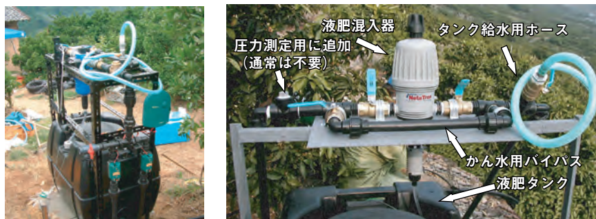
図3-5 液肥混入装置
