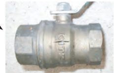
割れたボールバルブ
