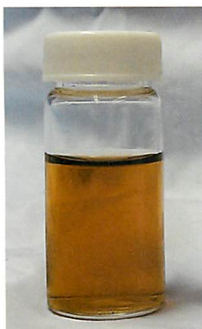
写真1 曝気処理した豚尿 十分に曝気した豚尿は臭いや濁りがなく、透明な褐色を呈し汚物感がない。
