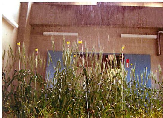
人工降雨実験施設における降雨試験の様子 （降雨強度：25mm/h）
