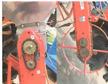
写真2 チェーンケース。 チェーンケースを2ヶ所に設け、スプロケットの組合せで施肥量を調整できるように加工した。
