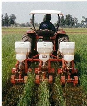
写真：改良播種装置を付けた播種機によるギニアグラスの播種作業
