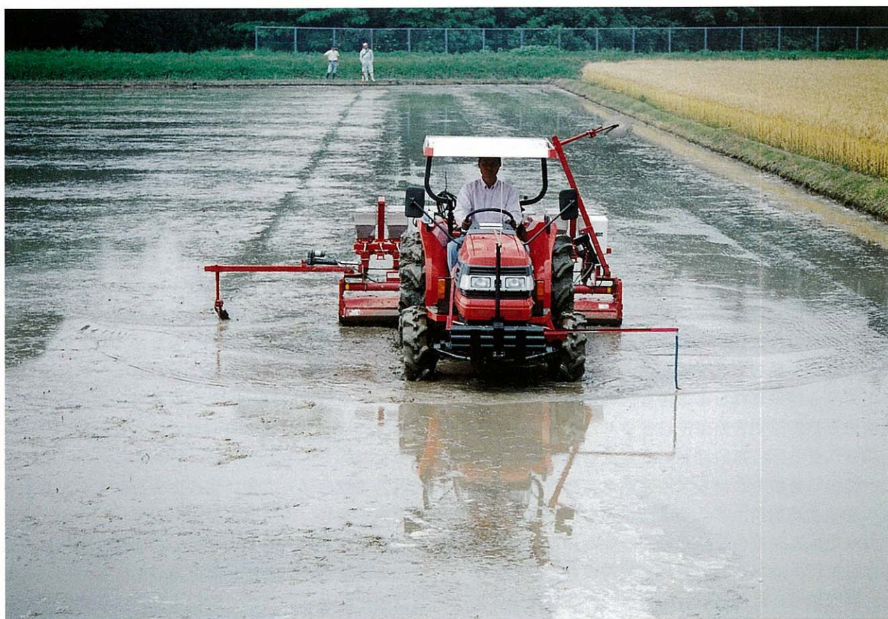
全国に普及し始めている打ち込み式代かき同時土中点播機（ショットガン直播機）による水稲の直播作業（福岡県夜須町） 写真提供：脇本賢三
