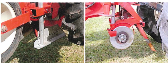
写真1 可変式覆土器(左)と溝切り器(右)
