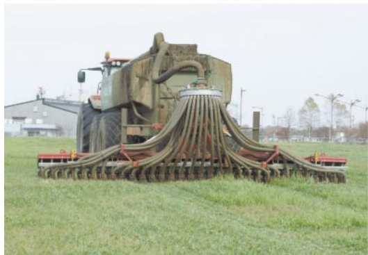
図 スラリー散布試験の様子：バンドスプレッター（上）インジェクター（下）
