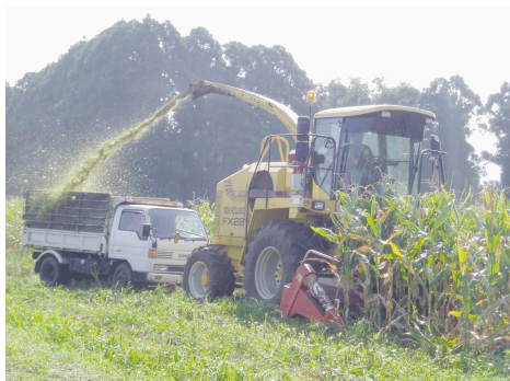
大型自走式ハーベスタによる 飼料用トウモロコシ収穫
