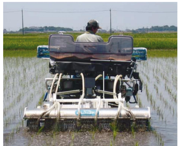
機械除草同時米ぬか散布の現地実証試験の様子 （田植え 10 日後、米ぬか 60kg 同時散布）
