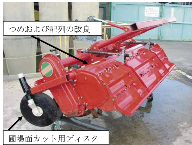
図 5-2-1 改良ロータリの外観
