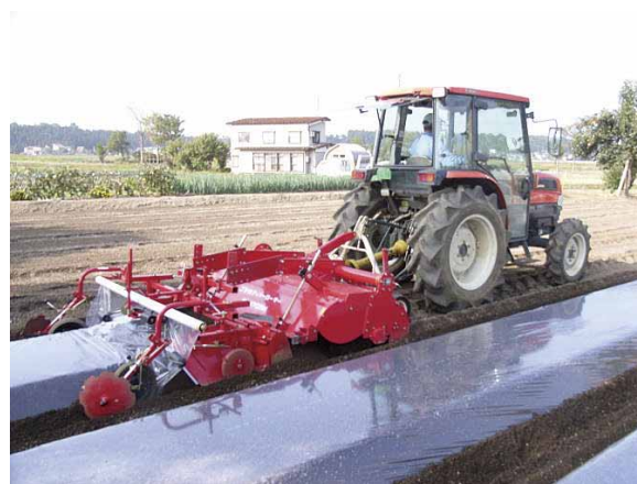
写真 2-3-2 耕うん同時畝立て・マルチ作業の様子
