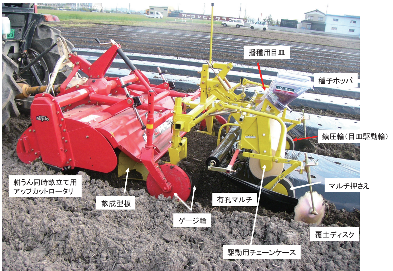
写真 1-2-3 有孔マルチを利用したマルチ直播作業機
