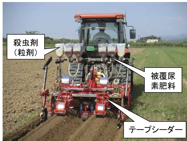
写真 2-6-1 同時作業機による作業風景
