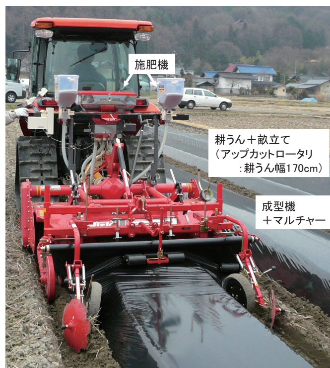
写真 1-2-4 耕うん同時畝立てマルチと施肥機の種類
