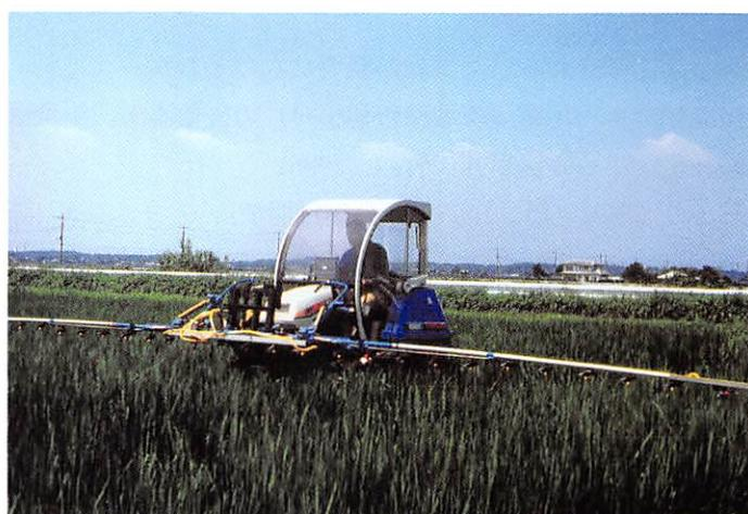
写真9 薬液少量散布用の乗用管理機
