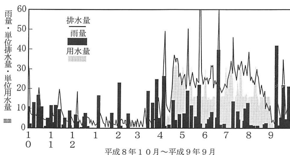
図2-1-18 用・排水基幹施設の稼働状況
