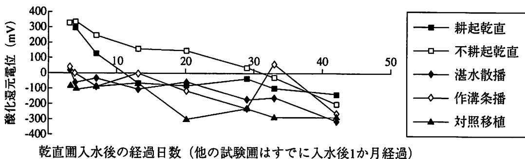
図1-1-5 各圃場における土壤の酸化還元電位の推移
