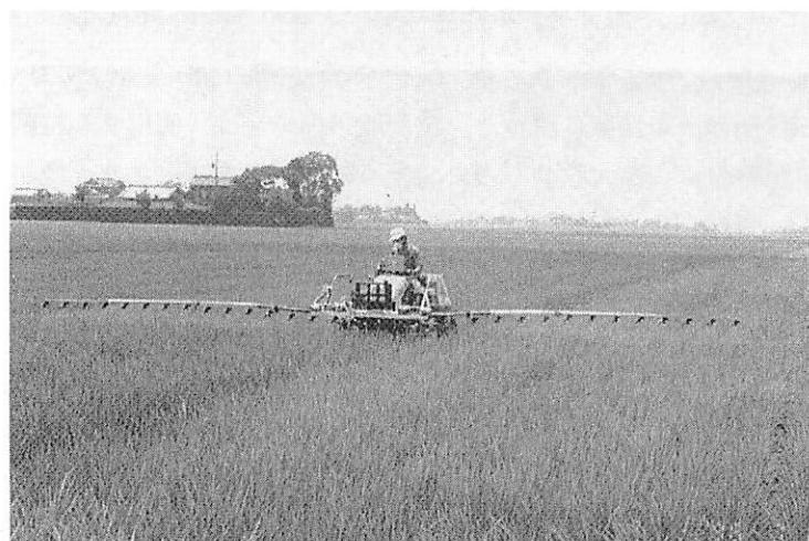
図 2-1-28 乗用管理機による液剤散布（除草剤・病害虫防除剤散布）作業
