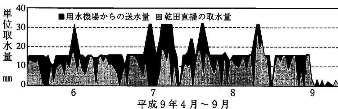
図2-1-19 用水機場からの送水量と自動給水器による乾田直播の取水量（平成9年）
