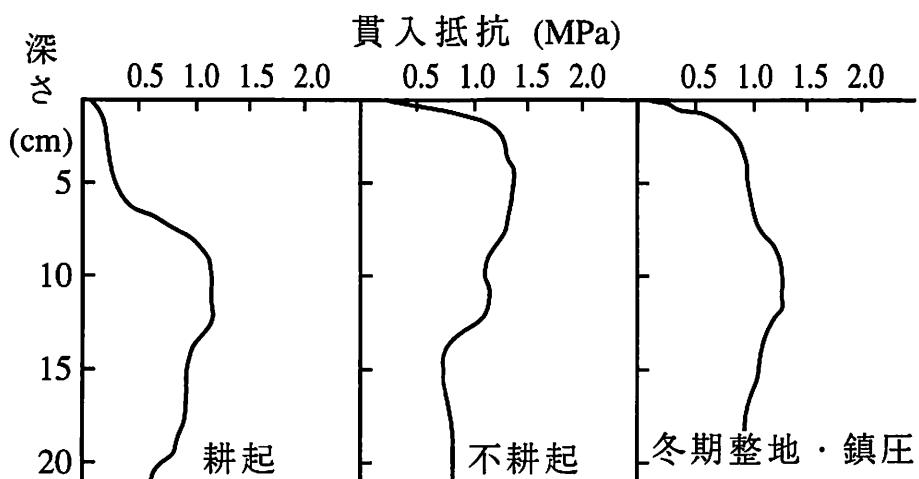
図4-1-2 耕起方法と播種時の土壤硬度
