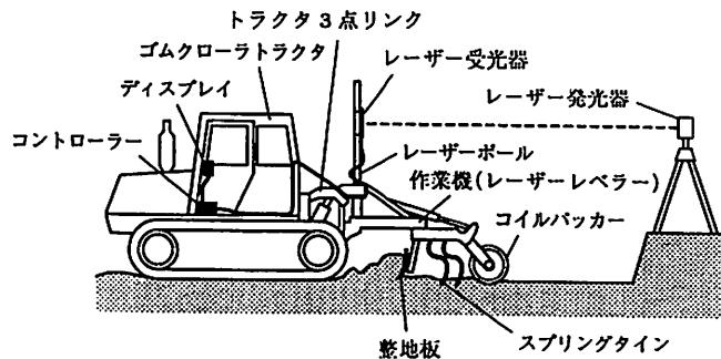
図2-1-24 全自動レーザー均平システムの概要
