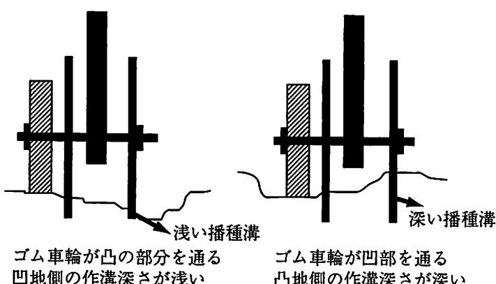
図4-1-3 2条独立懸架式の場合の圃場の凹凸による播種深度の変動
