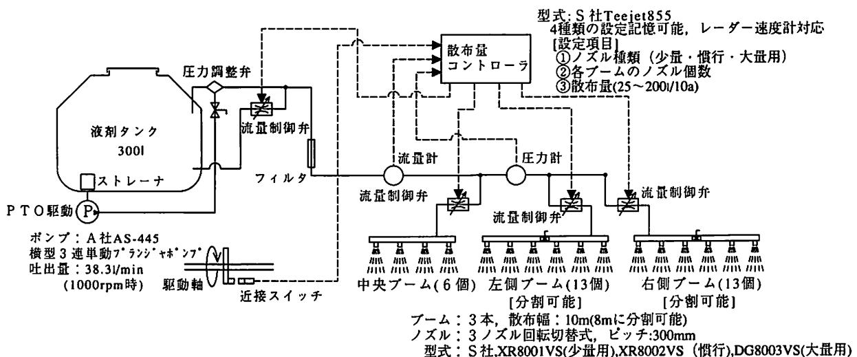
図2-1-26 乗用管理機用速度連動型少量散布装置制御システム図
