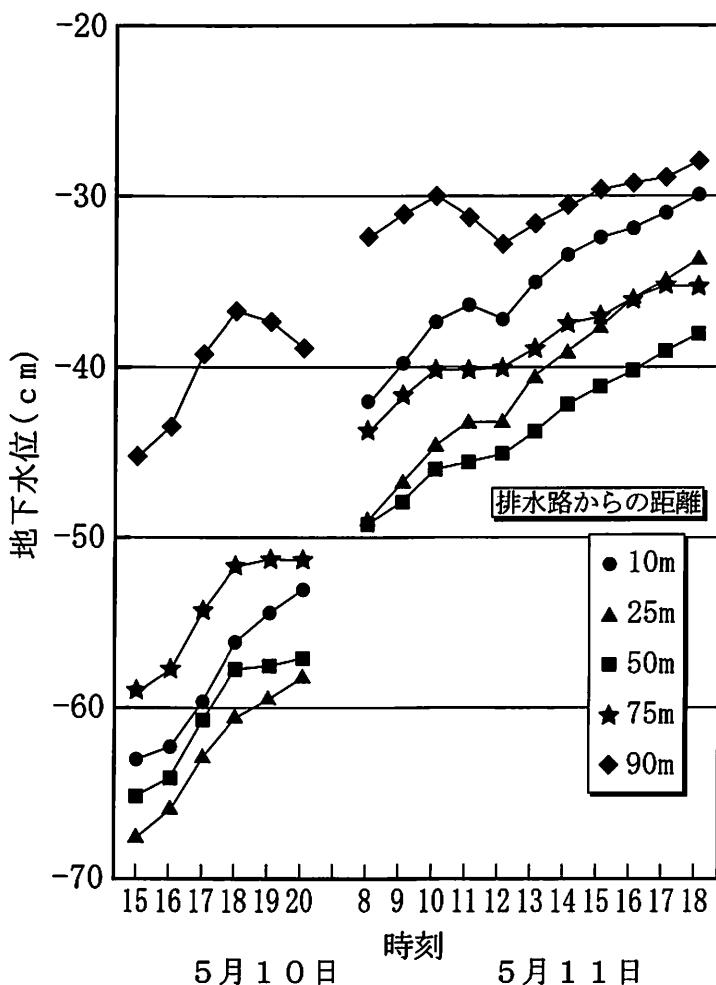
図2-1-21 地下灌漑に伴う地下水位上昇過程
