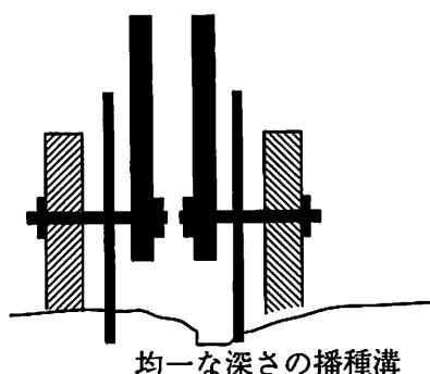
図4-1-4 各条独立懸架式の圃場田面の凹凸に対する追随性
