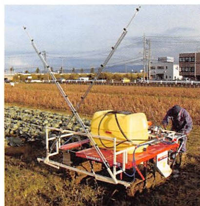
図2-1-2)-3 散布作業機(boom上方格納時)
