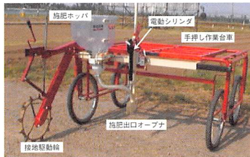
図2-1-3)-9 追肥作業機の構造（手押し台車装着）
