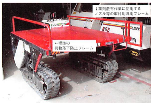
図2-1-2)-2 荷物落下防止フレーム
