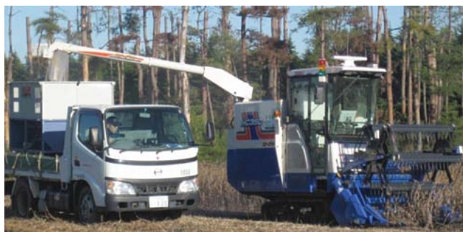
図2 自動収穫同時排出作業と制御システム
