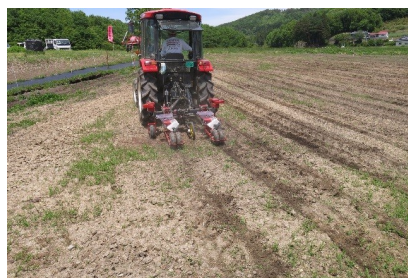
写真2 高速不耕起播種機
