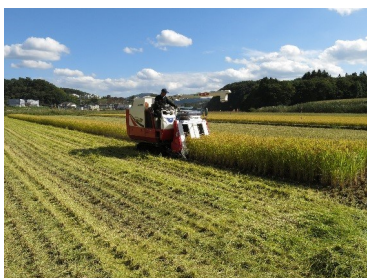
写真1 稲わら乾燥促進用 圧砕処理機能付きコンバイン
