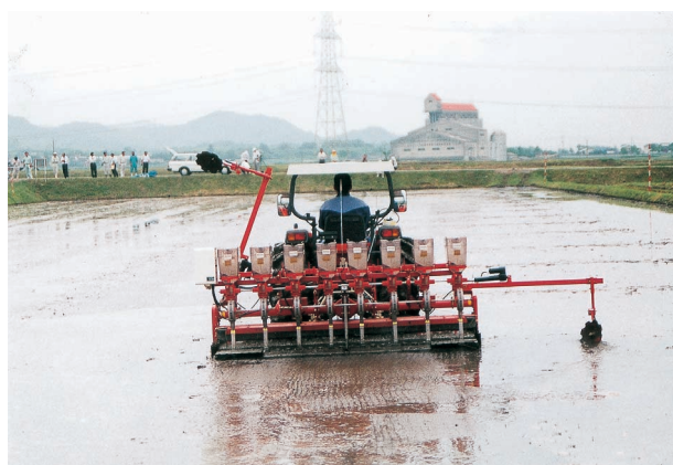
写真6 作業工程マーカを装着した代かき同時打込み点播機 (九州農試, 1998)
