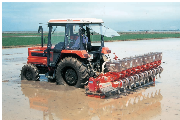
写真1 打込み点播機（鹿児島県出水市，1996）
