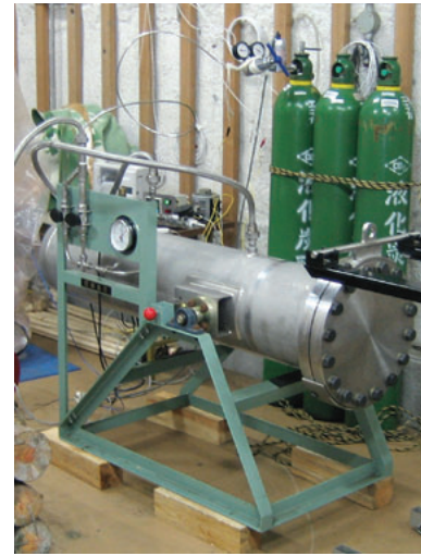
大型高圧炭酸ガス処理装置 サイズ:外径40cm、長さ155cm 処理量:クリ70kg/回
