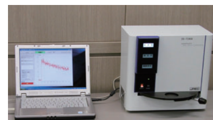
PSL測定装置の構造の概略と開発装置 (上:概略図、下:開発装置の写真)
