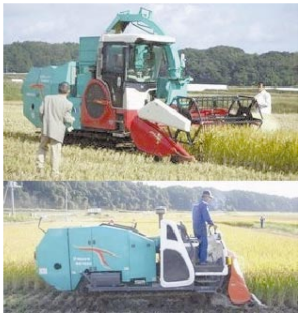
細断型ペーラを搭載した自走式収穫機 上段：汎用型飼料収穫機（リールヘッダ装着時） 下段：自走式細断型飼料イネ専用収穫機
