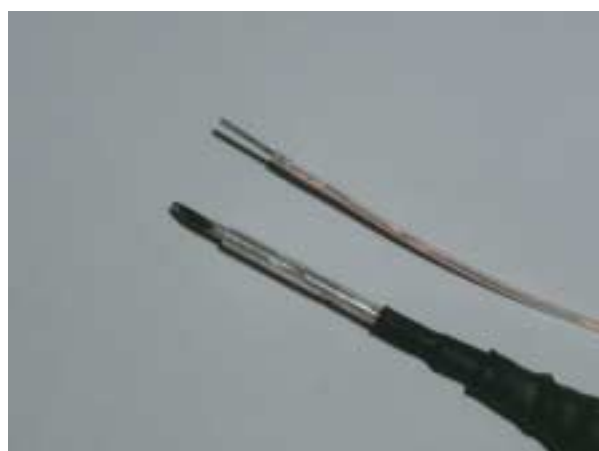
写真2 O_2^{\cdot -} 測定装置のセンサー部分(ニードルタイプ, 2種類) 採血後, 採血管ごとアルミニウムブロック恒温槽で37℃に保温し, その血液中にこれらのセンサーを浸して測定した。
