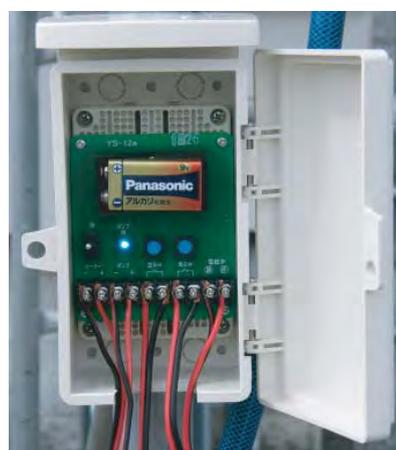
第2図 拍動自動灌水装置の制御装置
