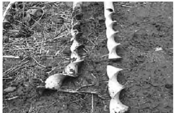
第10図 石礫によるスパイラル基礎杭先端の曲がり
