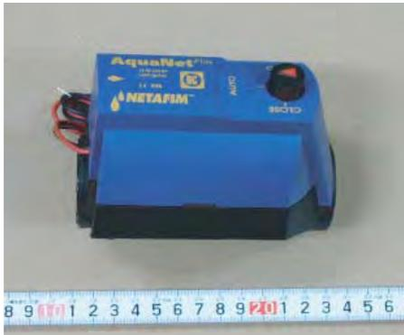
第5図 ラッチ式電磁弁 アクアネットプラス DC12-40V
