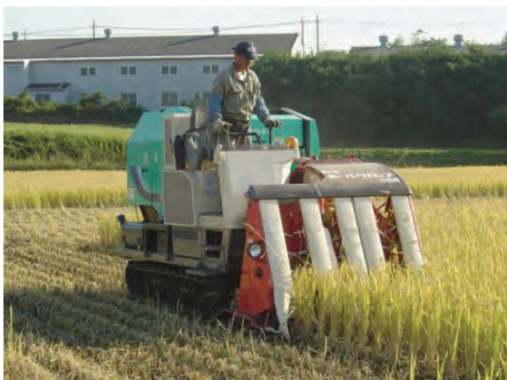
図3-36 コンバイン型飼料イネ用ロールベアラの例（T社WB-1000）
