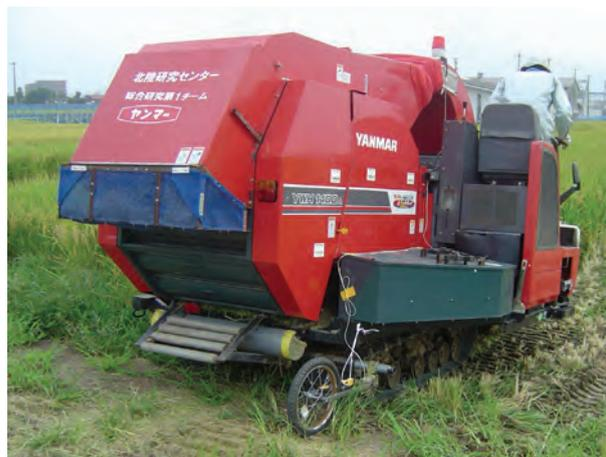
図3-41 排塵損失回収のために試作した回収ネット
