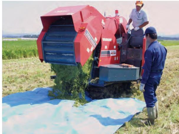
図3-42 排出時損失の回収作業
