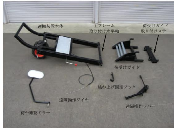
図3-57 ロールベール運搬装置の構成要素
