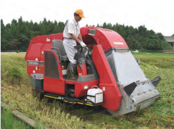
図3-62 純正の乳酸菌散布装置を装備した
