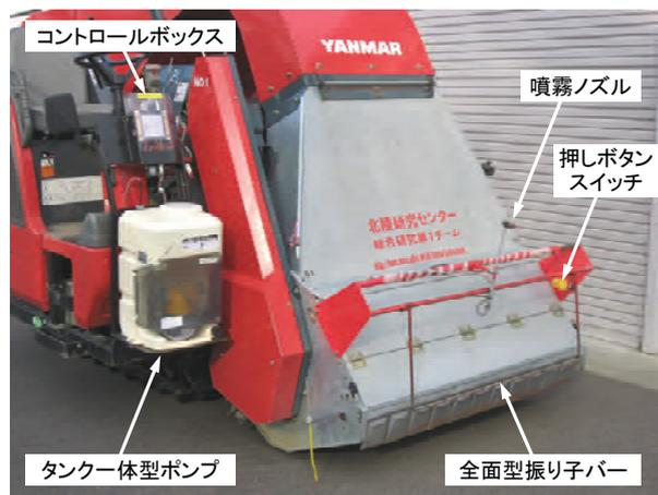
図3-68 乳酸菌散布装置の外観
