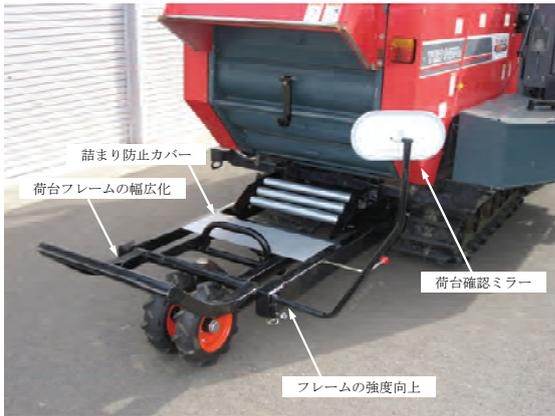
図3-56 開発したロールベール運搬装置の取り付け状態
