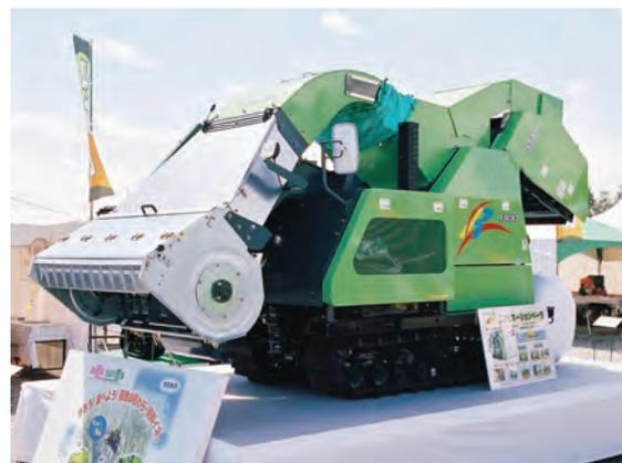
図3-37 フレール型飼料イネ用ロールベアラの例（S社JCB-1400）
