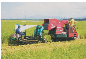
写真1 専用収穫機による飼料イネの収穫作業（右が飼料イネ用ロールベアラ、左が自走式ベールラッパ）
