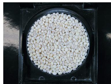
写真1 通常の方法による精麦白度測定材料（約25g）
