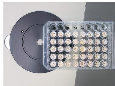
写真2 少量精麦によるハンター白度測定材料（約0.5g）
