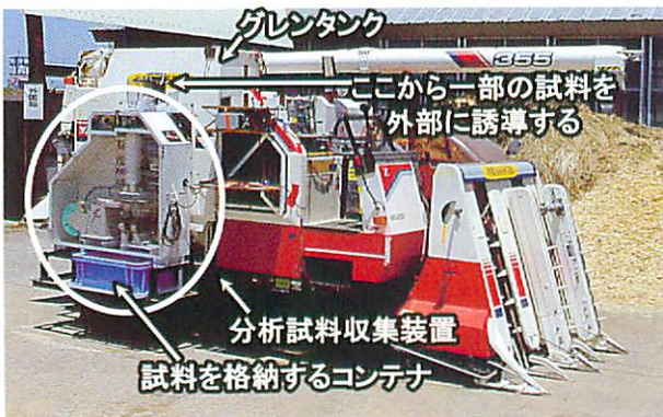
図1 コンバインに取り付けた分析試料収集装置
