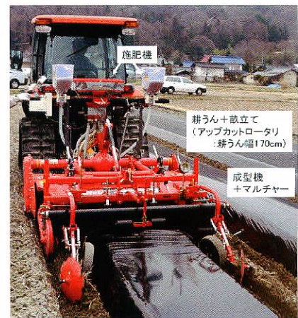
図2 耕うん同時畝立て施肥マルチ作業機
