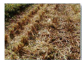
写真3 切断長60mmの稲わら（堆積高さ9.6cm）
